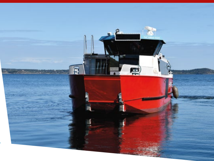
Die E-Fähre über den Fluss Glomma in Norwegen wird bis zu 150-mal pro Tag geladen, wenn Passagiere ein- und aussteigen.
